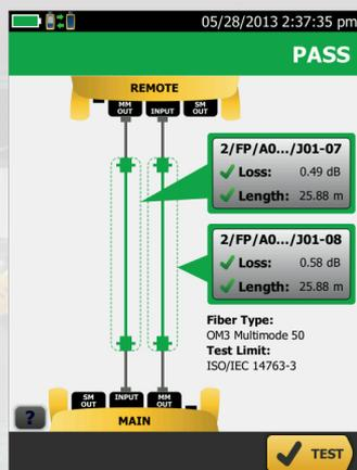
*С результатом тестирования отображаются полные данные. Пунктирная линия показывает, что включено в измерение. Окно подробных сведений отображает результаты для каждого тестируемого волокна.*
